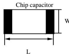
再流焊接时推荐设计的尺寸 (单位: mm)
